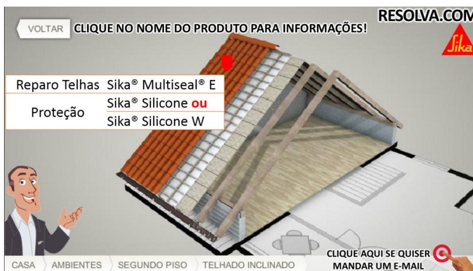
Figura 134 - Soluções para telhas no ambiente Telhados Inclinados
