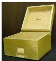
**1** – Faça furos na tampa da caixa para fixar o soquete da lâmpada e recorte um retângulo na face dianteira para encaixar o botão liga/desliga e o controle remoto por laser. Atenção o interruptor deve ficar na altura do centro de massa da bola de tênis para facilitar a execução da atividade.
