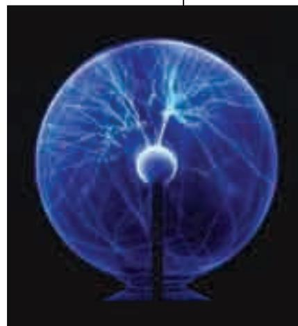
Os raios observados se devem ao processo de ionização e recombinação dos átomos e elétrons do gás pressurizado no interior do bulbo.
