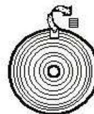
**5** - Cole as tampas no cilindro, deixando a fenda alinhada com a abertura. Fixe o pedaço recortado do CD na tampa com a abertura, usando a fita isolante apenas nas bordas. Preferencialmente, alinhe as linhas de gravação paralelamente à fenda do espectroscópio, assim as imagens que observaremos também estarão alinhadas com a fenda.
