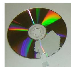
**3** - Retire a película refletora do CD usando fita adesiva (grude-a na superfície e puxe-a, como numa depilação). Se necessário, faça um pequeno corte com a tesoura no CD para facilitar o início da remoção.
