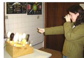
Você deve sempre ter certeza de que as cores visualizadas são referentes à fonte que está observando. Para isso basta tampá-la com o dedo e verificar se o espectro desaparece. Procure evitar direcionar o espectroscópio para posições entre duas ou mais lâmpadas.
