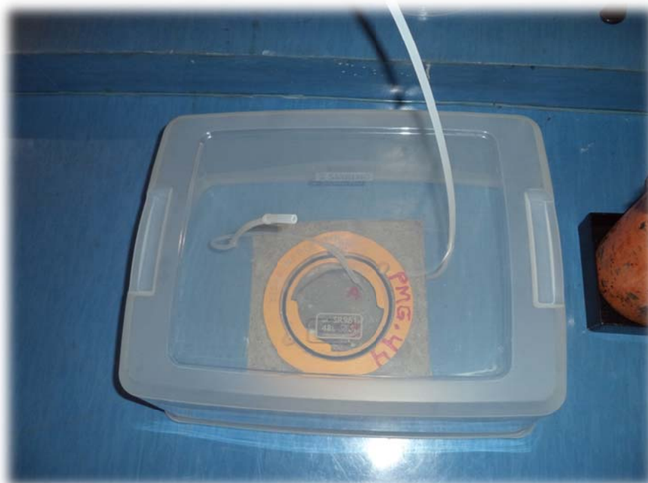
Foto 24 – Área de abrangência do teste de estanqueidade nos PMG.
