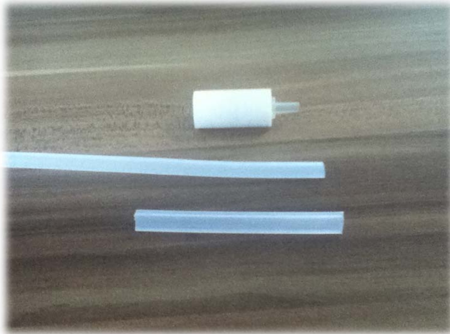
Foto 21 – Constituintes dos PMG: Pedra porosa, tubo polipropileno e tubo de silicone.
