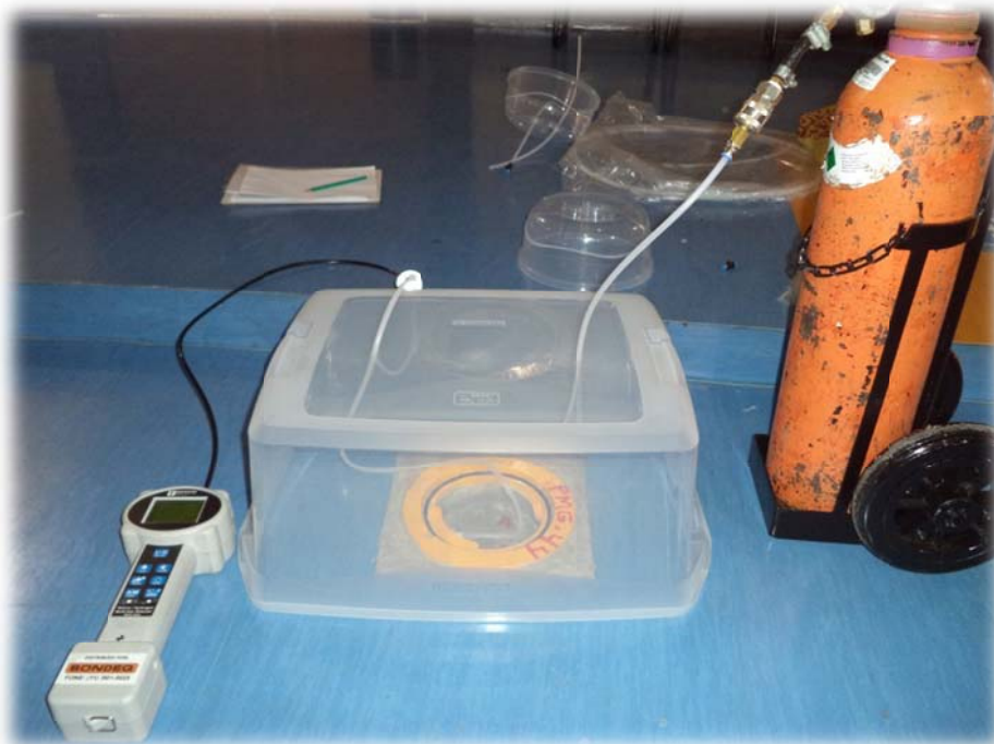
Foto 28 – Medição de hélio no PMG e averiguação da estanqueidade.
