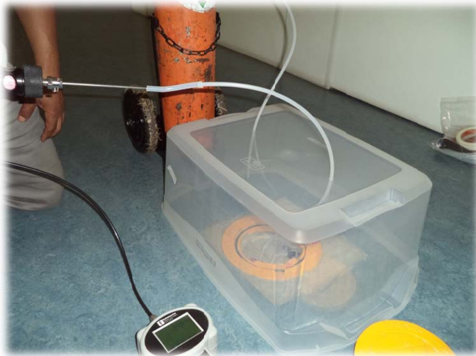
Foto 27 – Medição de hélio no PMG, após a comprovação da saturação de hélio na caixa plástica.
