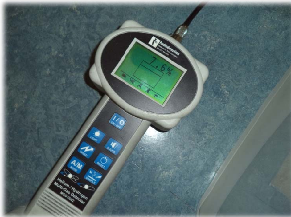
Foto 26 – Medição da concentração de hélio no interior da caixa plástica.
