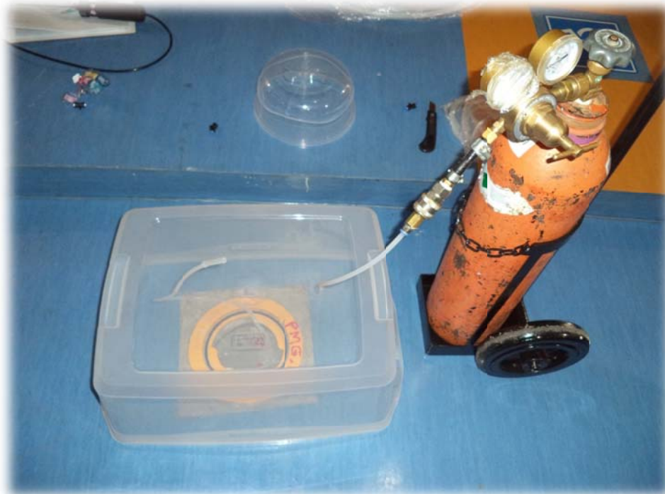
Foto 25 – Inserção de gás hélio no interior da caixa plástica até sua saturação.
