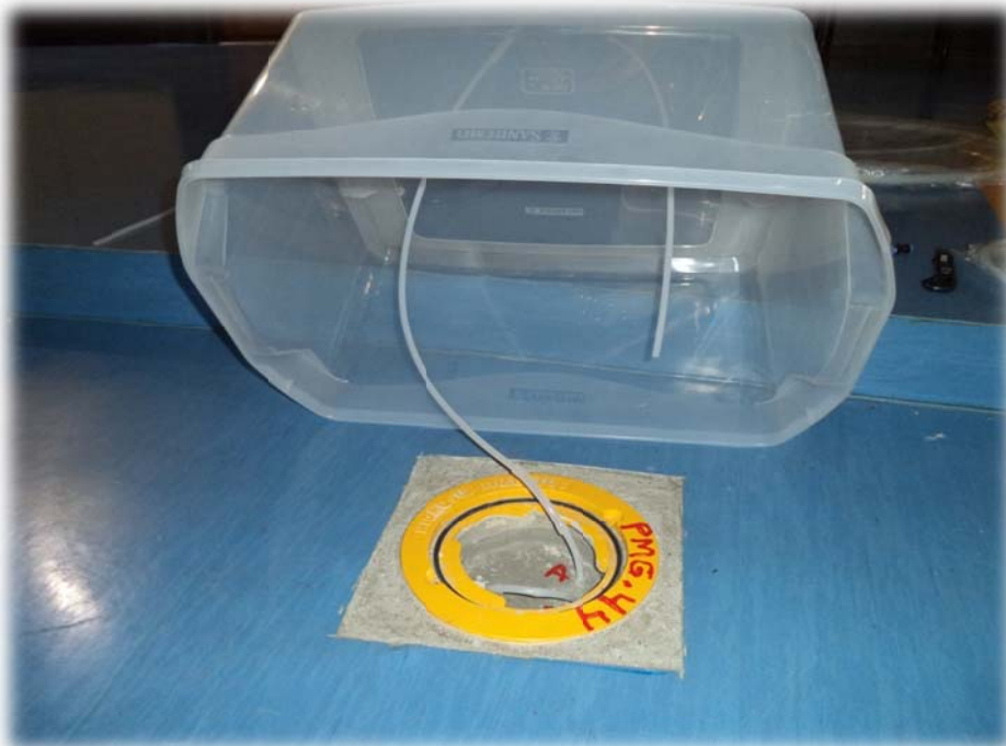
Foto 23 – Início do teste de estanqueidade.
