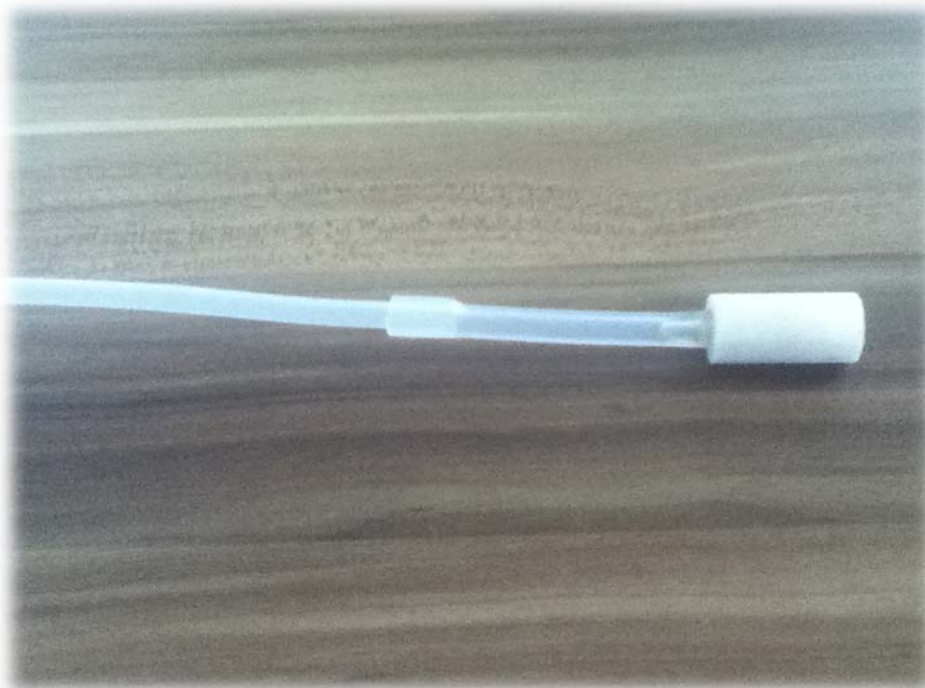
Foto 22 – Pedra porosa recebe o engate do tubo de silicone, que por sua vez recebe o engate do tubo de polipropileno de ¼ polegadas.
