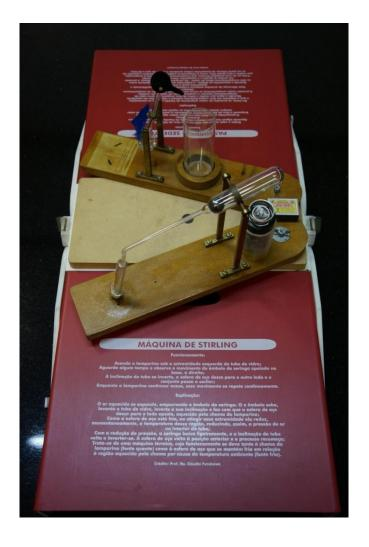
pressão, a seringa baixa ligeiramente, e a inclinação do tubo volta a inverter-se. A esfera de aço volta à posição anterior e o processo recomeça; Trata-se de uma máquina térmica, cujo funcionamento se deve tanto à chama da lamparina (fonte quente) como à esfera de aço que se mantém fria em relação à região aquecida pela chama por causa da temperatura ambiente (fonte fria).
