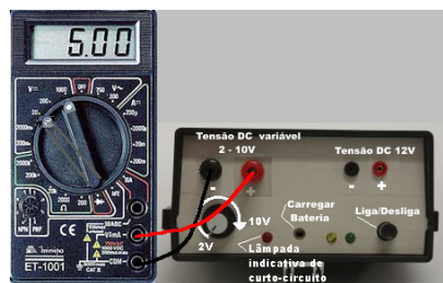
Figura 1.3 – Ajustando a fonte de corrente contínua para fornecer 5,00 V
