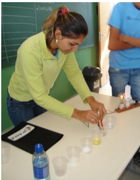
Figura 4 - Aferição da soda cáustica com excesso de umidade.
