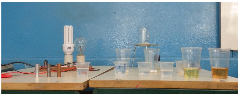
Figura 3 - Materiais para experimento de condutibilidade elétrica das substâncias.
