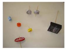
Figura 3 - Os diferentes tipos de piões que foram confeccionados e utilizados na experiência para verificar se o tamanho do palito interferia na forma do pião girar.
