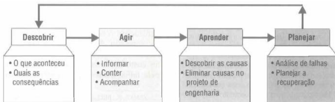
Figura 2- Falhas – processos e planejamento de recuperação
