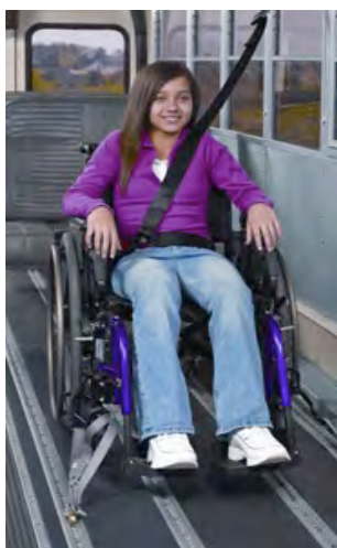
Figura 8.11 – Mecanismos de/instruções para travamento da cadeira de rodas
