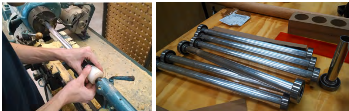
Figura 4.28 – Adição de rolamentos ao mecanismo
