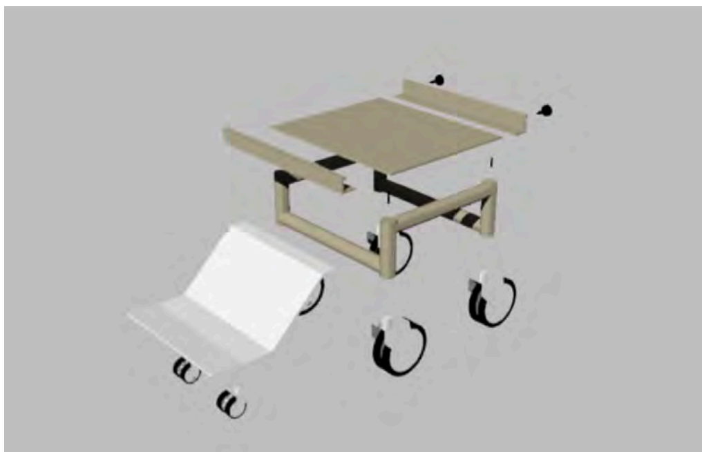
Figura 8.31 – Visão explodida da estrutura da cadeira
