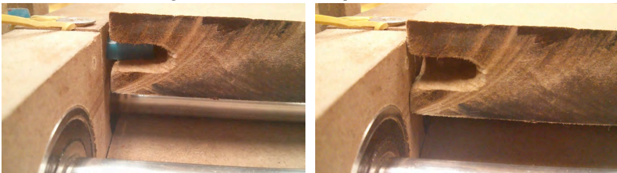
Figura 4.34 – Base travada à esq. e destravada à dir.
