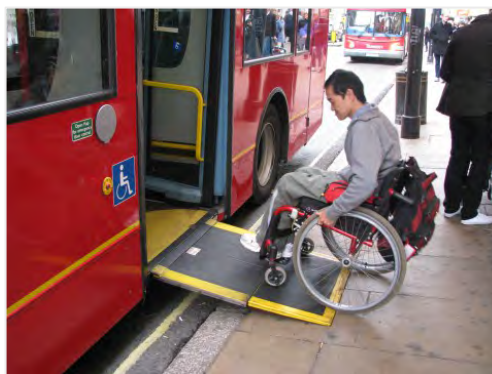
Figura 8.7 – Rampa retrátil de ônibus para pessoas com mobilidade reduzida
