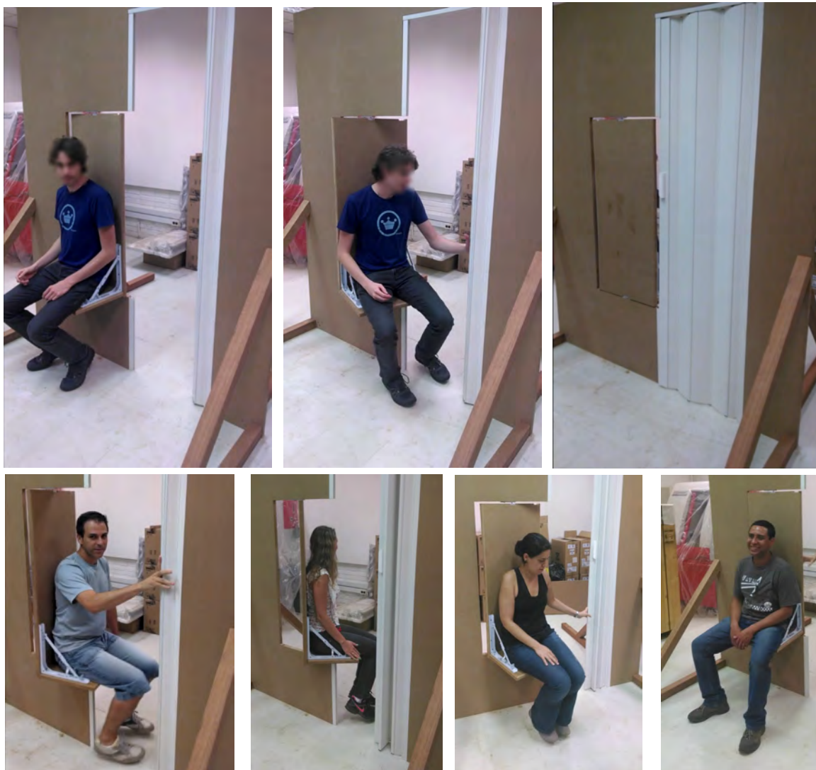
Figura 4.17 – Protótipo em tamanho real do banheiro giratório
