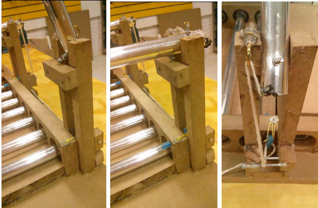
Figura 4.33 – Da E p/ a D: braço levantado e mecanismo travado, mecanismo travado e vista traseira
