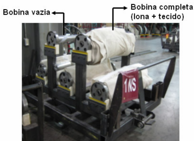
Figura 3.6 : Carro utilizado na armazenagem e transporte das bobinas de lonas de topo
