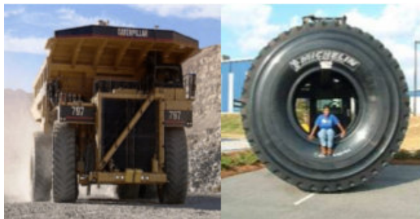
Figura 1.4 : O pneu “59/80 R 63 XDR C4 E4R TL” tem 4,03 m e pesa 5,3 t
