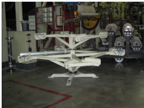
Figura 3.7 : Estrutura para a armazenagem das bobinas de lonas de topo ao lado das máquinas de acabamento
