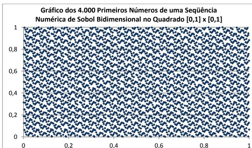
Figura B.2 – Gráficos exibindo uma seqüência de quatro mil números de Sobol distribuídos uniformemente no quadrado  $[0,1] \times [0,1]$ .
