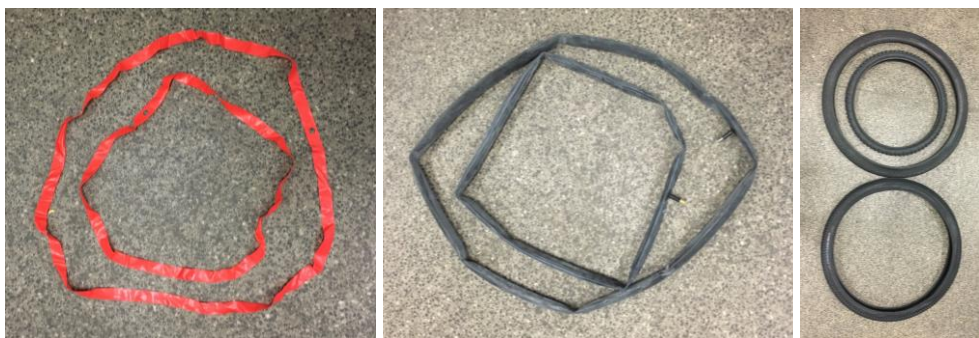
Figura 35 – Fitas de aro (esq.) e câmaras de ar (c.) dos tamanhos 20 (internas) e 26 (externas) e pneus (dir.) dos tamanhos 20 (interno), 26 para o aro de alumínio (externo) e 26 para o aro de aço cromado (abaixo).
