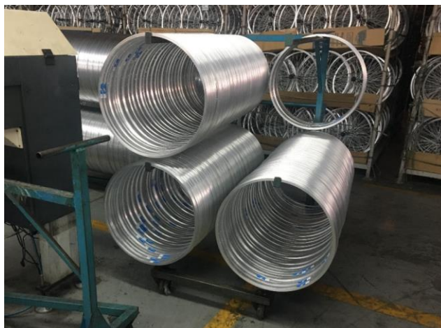
Figura 20 – Aros de roda em processo armazenados nas estações móveis.
