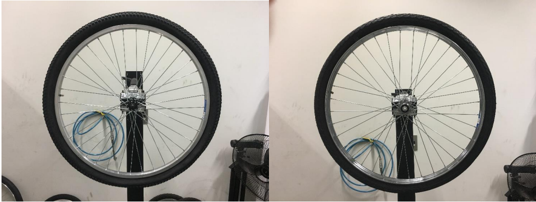
Figura 16 – Componente roda de alumínio (esq.) e de aço cromado (dir.) tamanho 26 finalizado.
