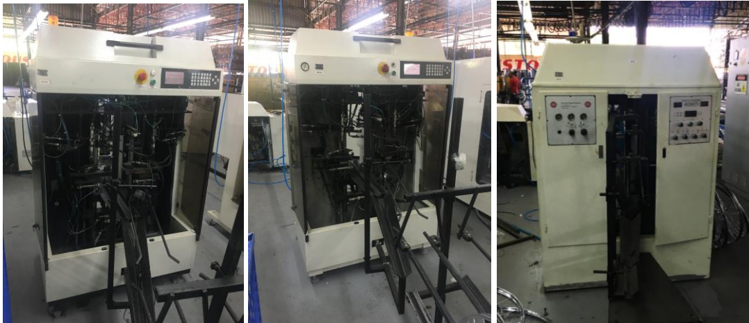
Figura 40 – Robôs DC-C (esq.), DC (c.) e DA (dir.) de operação automatizada de alinhamento e de tensionamento.
