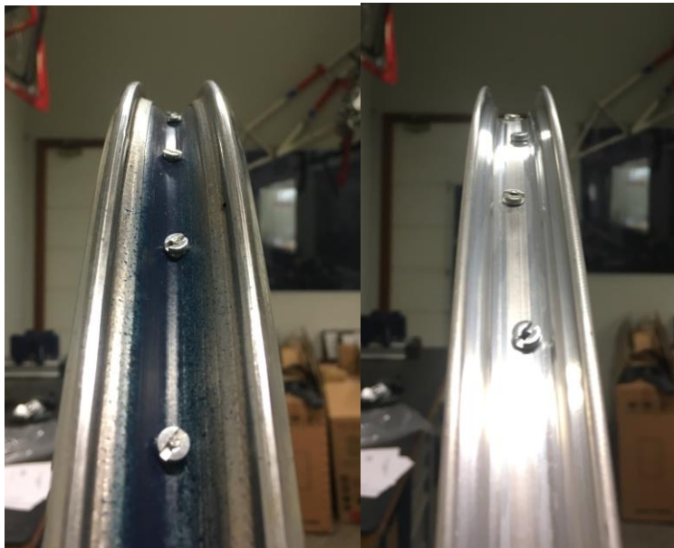
Figura 53 – Vista interna de furação de aros tamanho 26 de aço cromado (esq.) importado e de alumínio (dir.) fabricado internamente.
