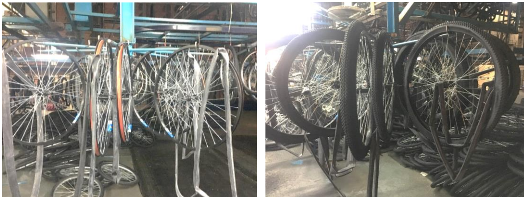
Figura 24 – Carrossel de conjuntos aros com câmara de ar para pré-embeijamento.
