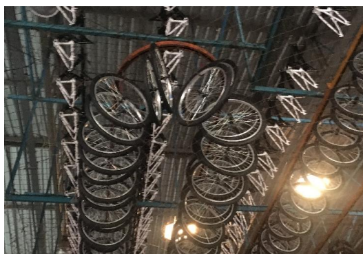
Figura 25 – Monovia de teto para colocação de pares de rodas finalizados, levados à linha de montagem.
