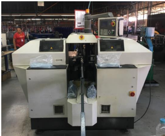
Figura 37 - Robô HFS preenchedor de cubos de roda.
