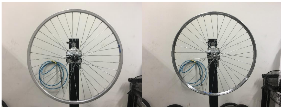
Figura 15 – Aros enraiaados de alumínio (esq.) e de aço cromado (dir.) tamanho 26, com 36 furos.
