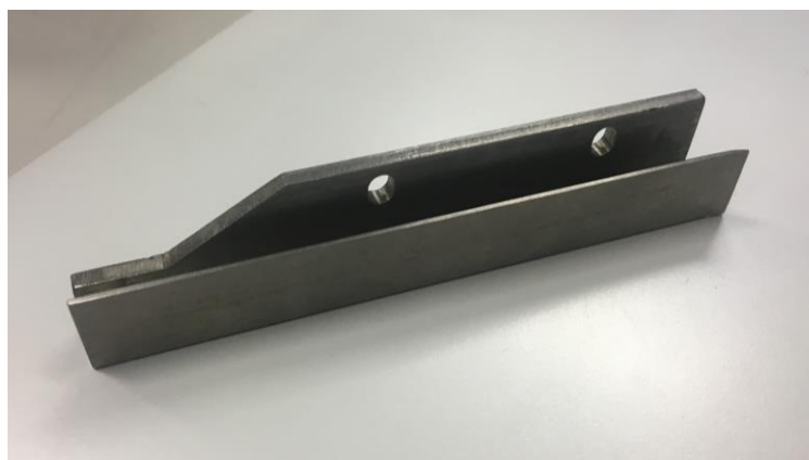
Figura 52 – Guia de inserimento de raios do robô HFS de fabricação interna da Houston Bike.
