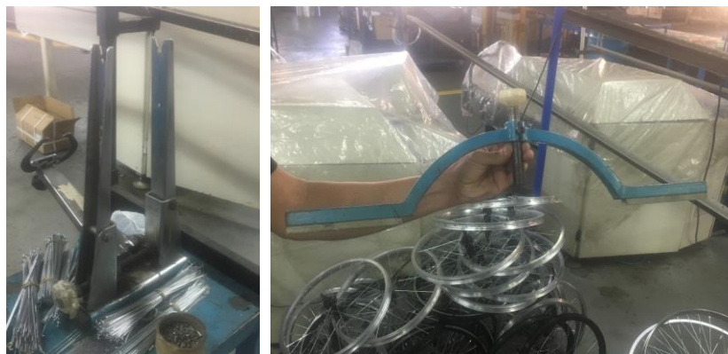
Figura 54 – Gabaritos de análise de alinhamento (esq.) e de empeno (dir.) de aro enraiado.
