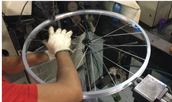
Figura 21 – Enraiador posicionando as extremidades livres dos raios nos furos dos aros.
