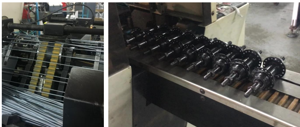
Figura 18 – Abastecimento de raios e cubos na Hub Filling Station (HFS).
