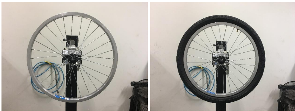
Figura 17 – Aro enraçado de alumínio tamanho 20, com 28 furos (esq.) e roda de alumínio tamanho 20 na forma enviada à linha de montagem (dir).
