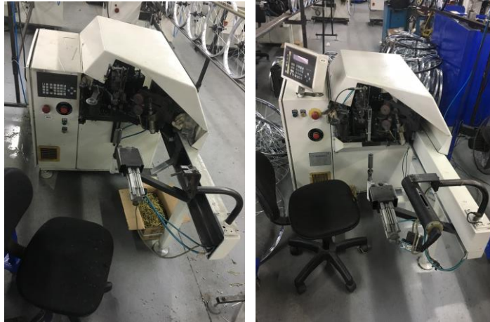
Figura 38 – Máquinas de enraimento dos modelos CL (esq.) e ISL (dir.).
