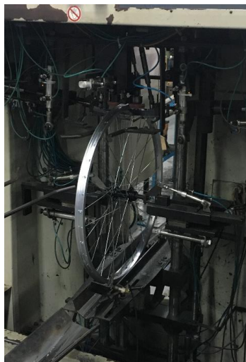
Figura 22 – Robô realizando o alinhamento e tensionamento de aro enraiado.
