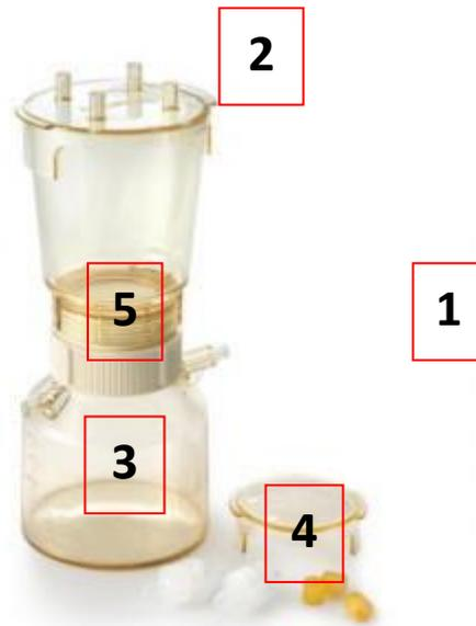
Legenda: Constituintes do sistema de filtração: funil (1), tampa do funil (2), frasco coletor (3), tampa do frasco coletor (4) e suporte de filtração (5). Autoria própria.
