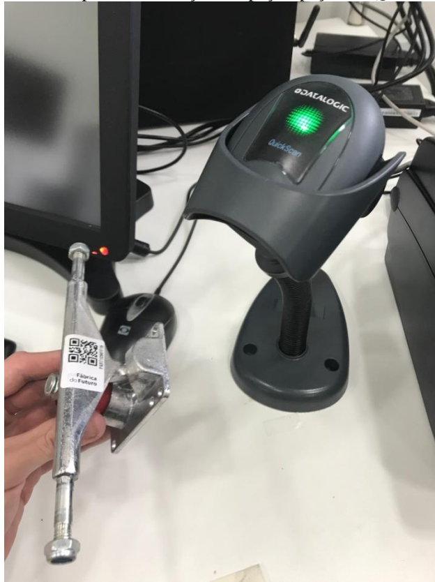
Figura 30 - Sistema para identificação das peças: peça com QR Code único e leitor
