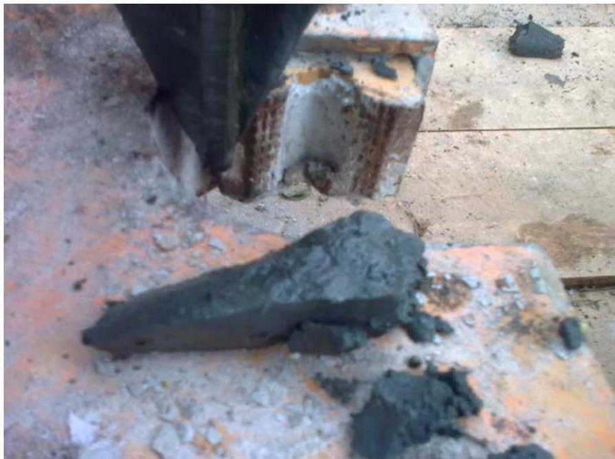
**Fotografia 27:** Amostra de solo retirada após o início da perfuração.
