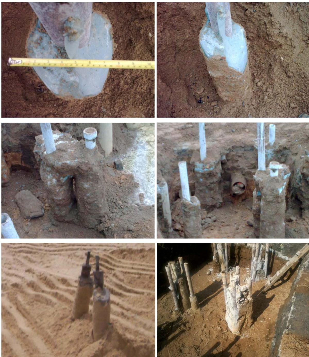
**Fotografia 8:** Estacas injetadas autoperfurantes exumadas em solos coesivos e não coesivos para verificação do seu diâmetro final.
