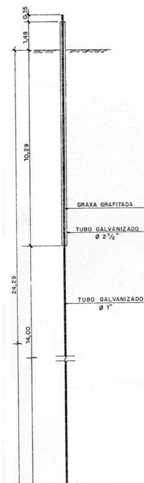
**Figura 52:** Perfil da instalação do marco de referência.
