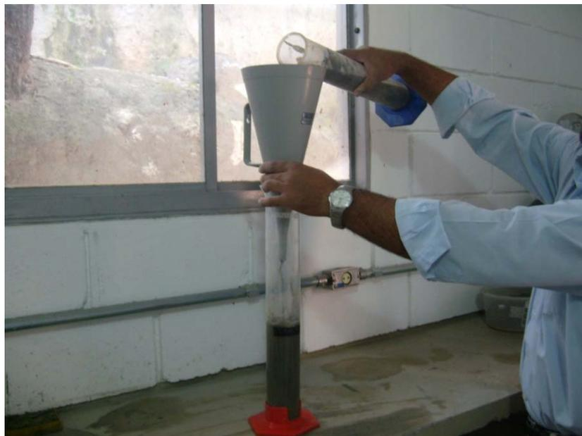
**Fotografia 14:** Ensaio de fluidez em Cone tipo Marsh.
