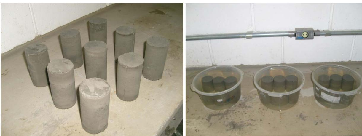
**Fotografia 13:** Moldagem de corpos de prova e imersão em água.
