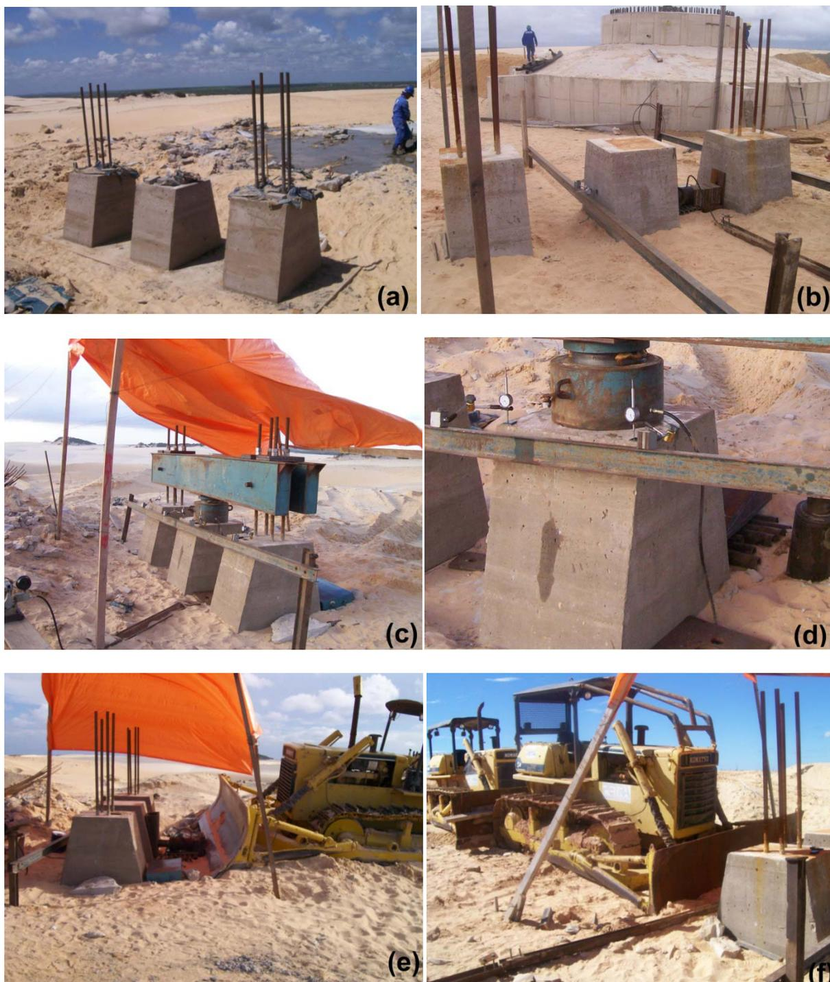
**Fotografia 21:** (a/b) cavalete para ensaio, (c/d) sistema de reação para ensaio de compressão, (e/f) prova de carga horizontal.
