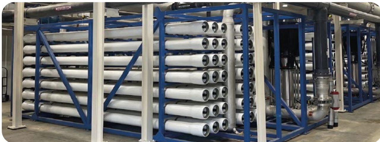
Figura 6. Exemplo de um equipamento de nanofiltração (Fonte: HOH Water Technology)
