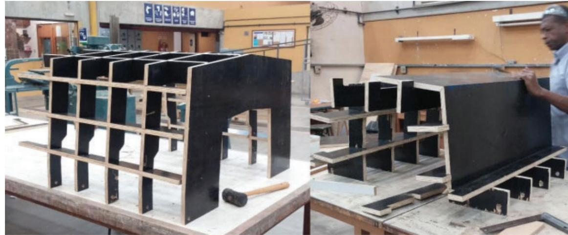
Figura 7 – Protótipo em escala de forma em madeira feito com máquinas de fabricação digital. Fonte: CAMPOS (2017)
