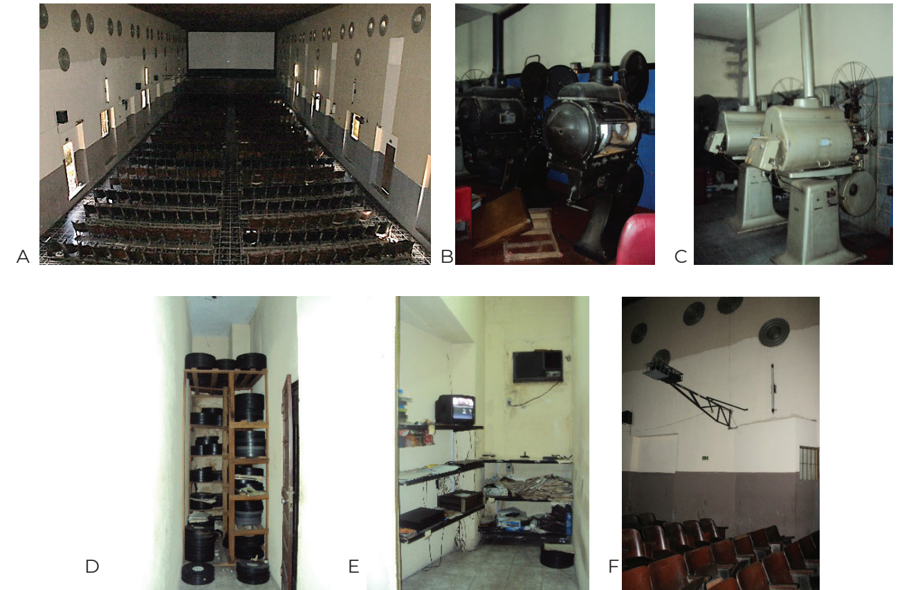
Figura 3: (A) Interior da sala de exibição visto do mezanino, é possível observar o posicionamento da tela e orientação e alinhamento das poltronas de madeira, na porção superior da imagem os elementos do sistema de ar insuflado; (B) Aparelhos de projeção movidos a carvão, originais do cinema; (C) Aparelhos de projeção movidos a carvão, adquiridos após o fechamento do Cine Vitória, localizado no bairro da Pedreira em Belém-PA (D) Armazenamento das películas em sala ar refrigerada, que tem acesso a partir da sala de exibição; (E) Armazenamento do aparelho DVD player e dos títulos em DVDs que são exibidos na sessões diárias do cinema, na mesma sala onde ficam armazenadas as películas; (F) Aparelho de projeção de filmes, visto a partir da sala de exibição, próximo ao palco localizado abaixo da tela de projeção. Fonte: Salma Nogueira Ribeiro (2013).
