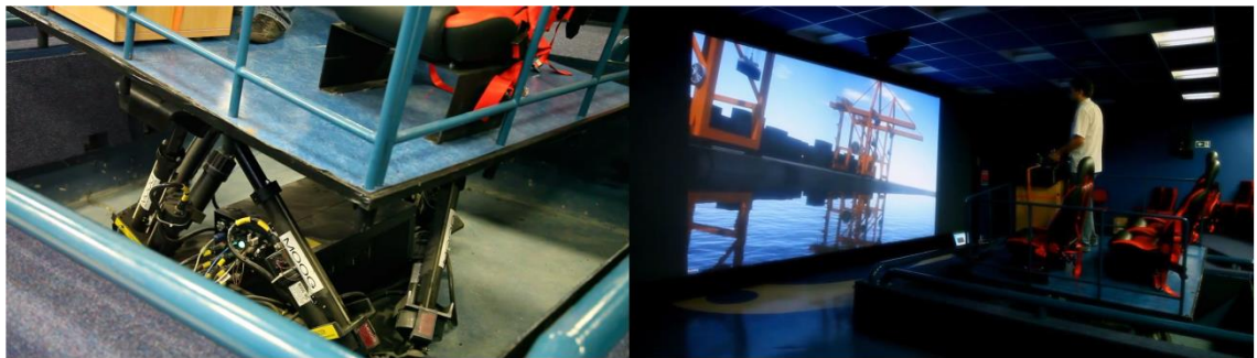
Figura 3 - Simulador 4D do Tanque de Provas Numérico, acionado por uma plataforma de Stewart
