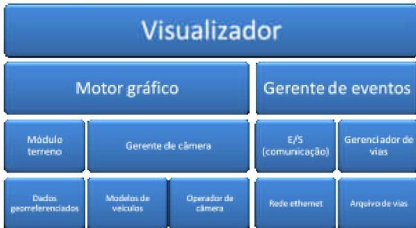
Figura 1 - Arquitetura esquemática do novo visualizador
