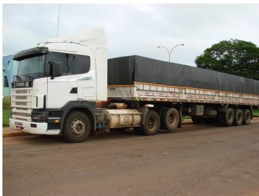
Figura 1: Exemplo típico de um arranjo carreta-cavalo mecânico
