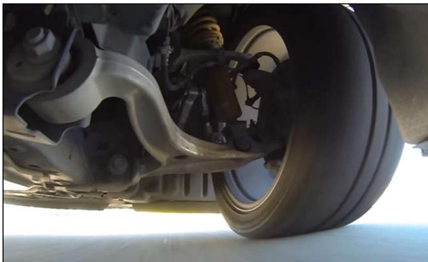
**Figura 1 – Deformação Lateral do Pneu (internet)**
