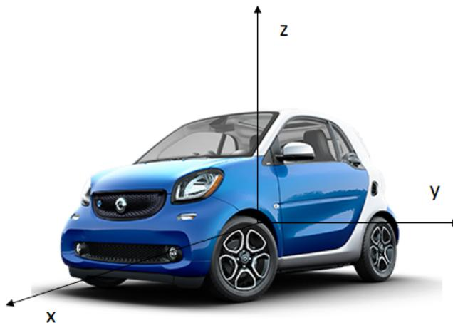
Figura 5: Eixos de referência do veículo
