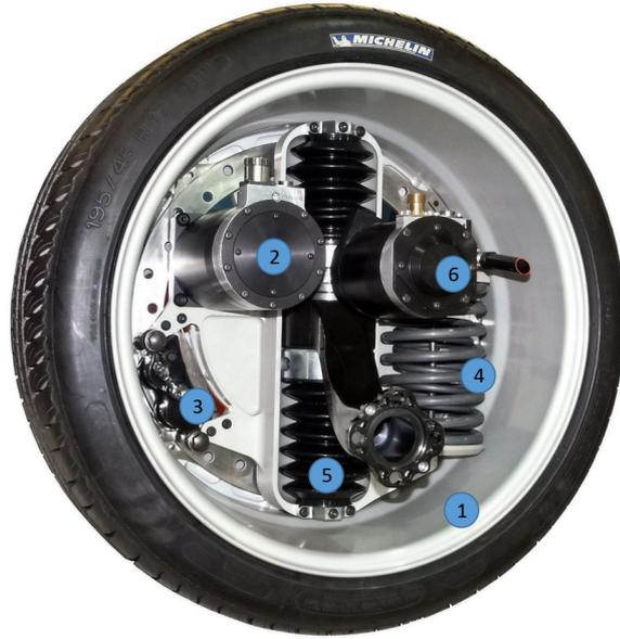
Figura 4: Sistema Michelin Active Wheel Drive (adaptado de [2])
