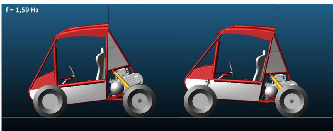
Figura 4-4 - Modo de arfagem. Frequência: 1,59 Hz
