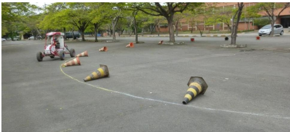
Figura 5-5 - Teste de curva de raio constante
