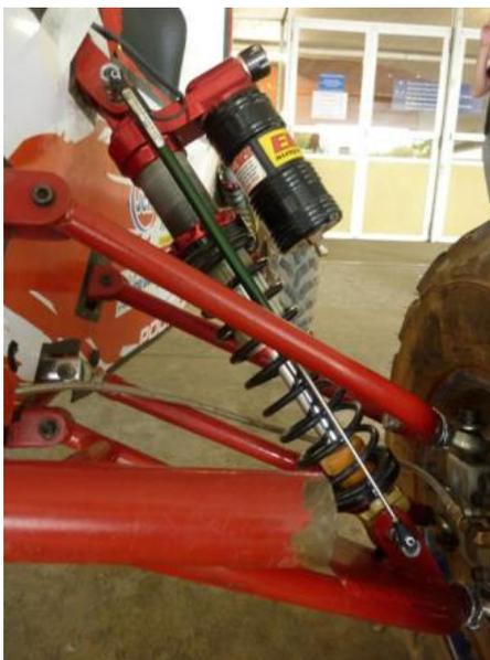
Figura 5-4 - Sensor de posição do amortecedor instalado no veículo
