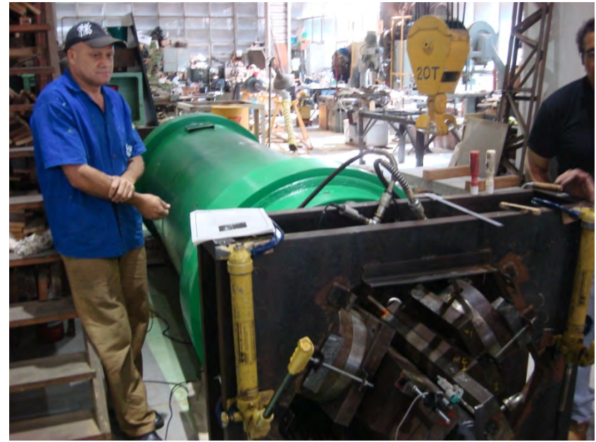
Montagem para a Medição do Coeficiente de Atrito Externo
