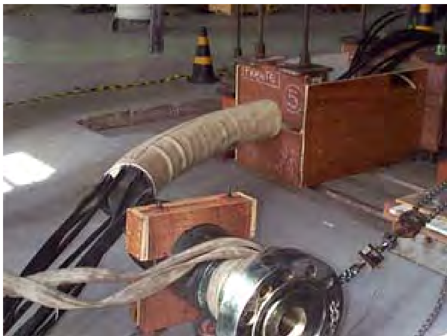
Aplicação da Carga no Teste de Medição da Rigidez à Flexão
