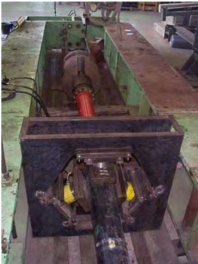
Teste de Compressão Radial 3 V's sob Tração
