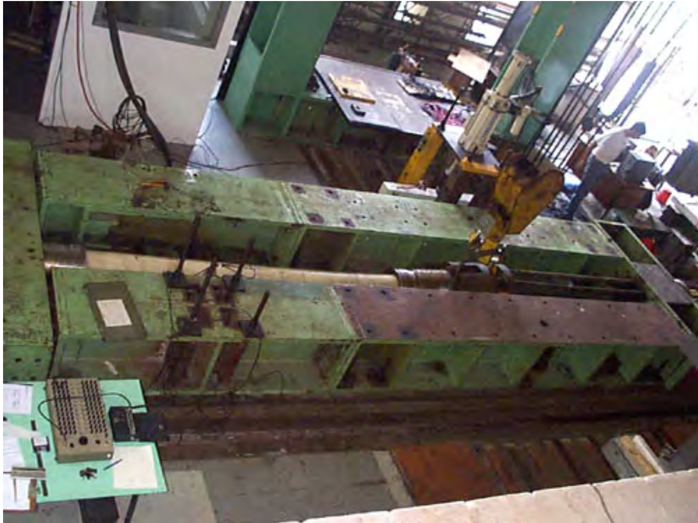
Vista Superior da Bancada para Tração do Corpo de Prova
