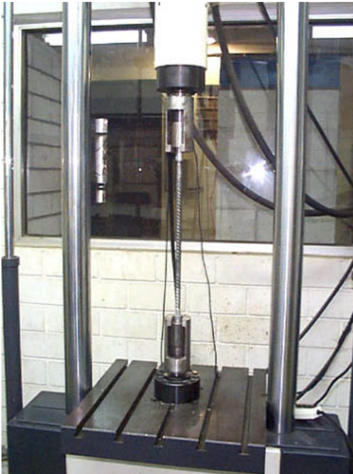
Corpos de Prova de Barras para Concreto Armado sendo Ensaaiados à Fadiga
