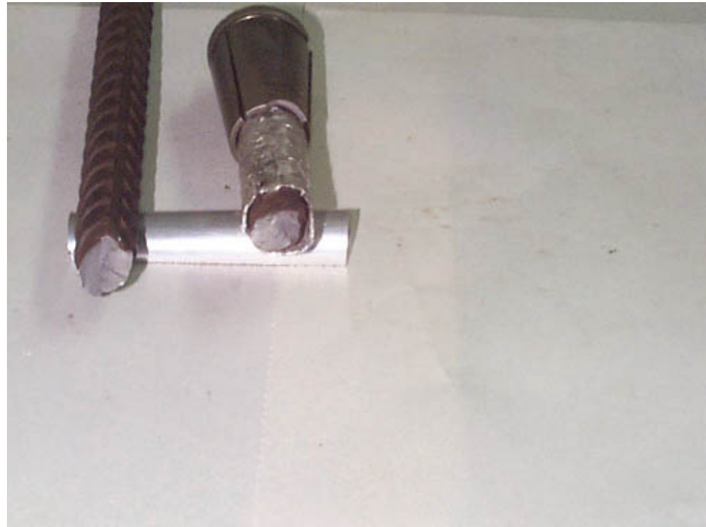
Corpos de Prova com Extremidades Tratadas e Clavetes
