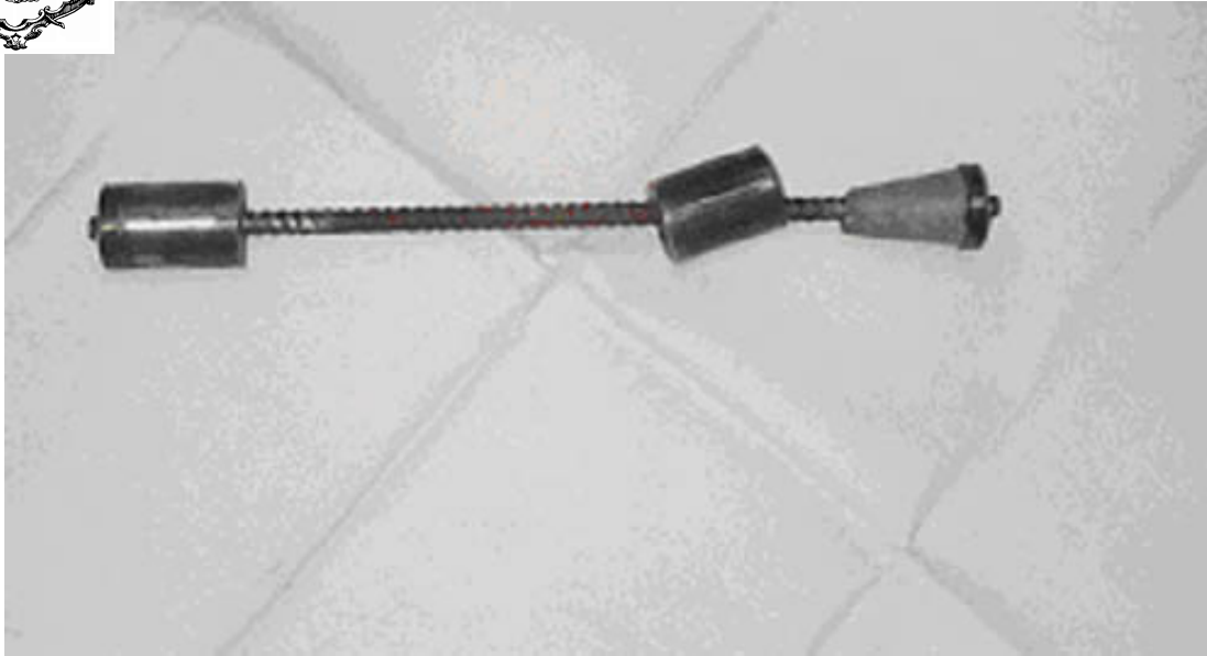
Corpos de Prova com Extremidades Tratadas e Garras Especiais
