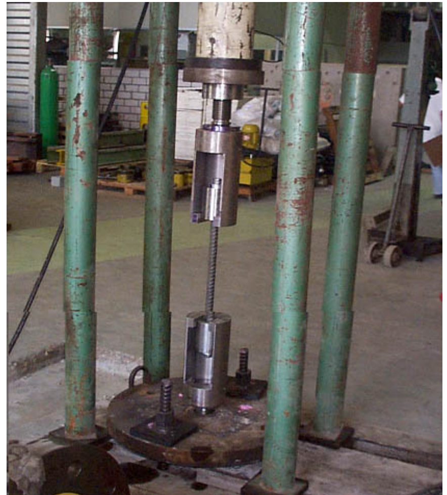
Corpos de Prova de Barras para Concreto Armado sendo Ensaaiados à Fadiga
