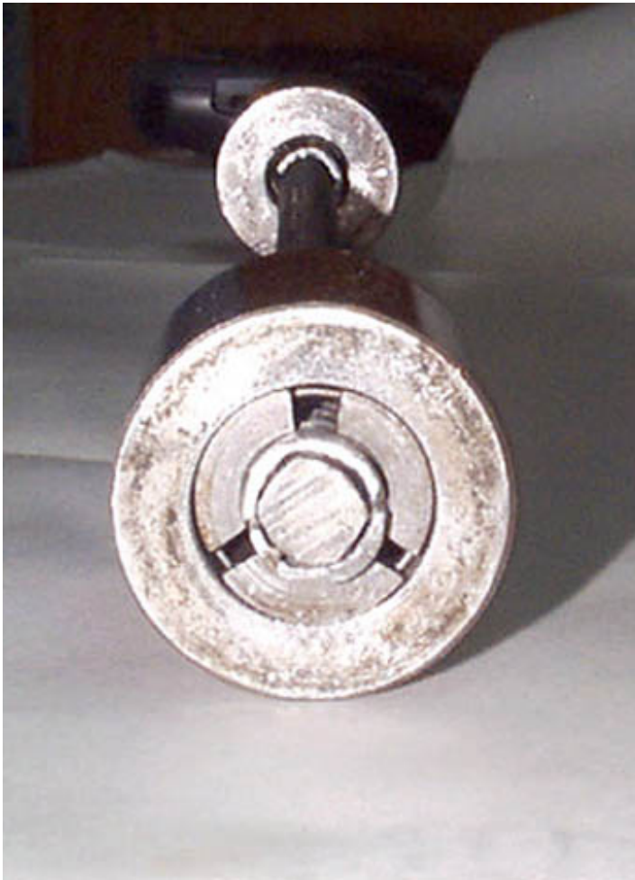
Corpos de Prova com Extremidades Tratadas e Clavetes
