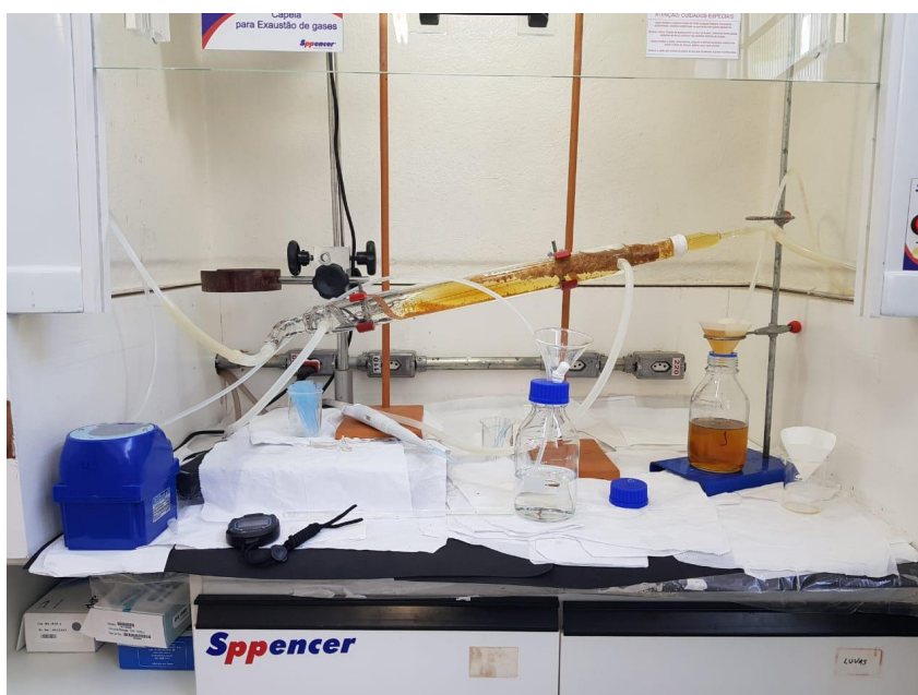
Figura 1 - Montagem reator tubular
