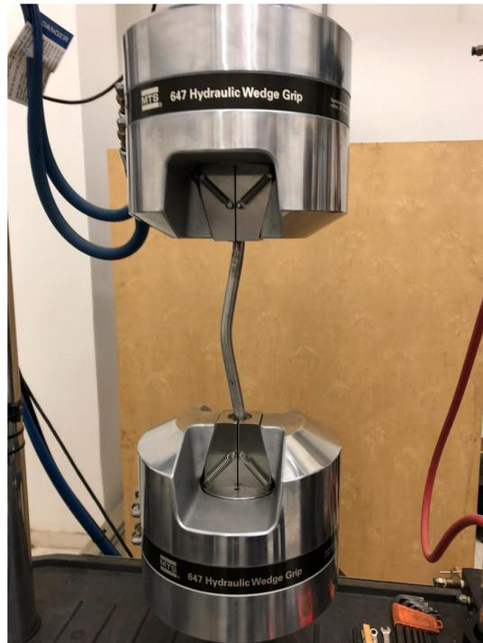
Figura 5.1 – Deformação permanente introduzida pelo ensaio.
