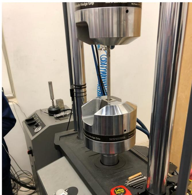
Figura 3.1 – Fotos de um dos ensaios antes da ocorrência da flambagem.
