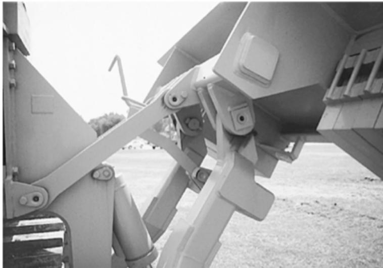
Figura 1.1.2 - Partes móveis de maquinaria, como este elo curto, estão sujeitos a cargas de compressão e, assim, agem como colunas.
