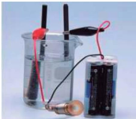
**Figura 2:** Aparato para verificação da condutividade da solução.
