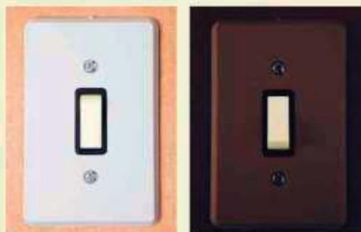
Os interruptores feitos de material fosforescente são visíveis no escuro devido ao retorno gradual dos elétrons que foram excitados durante o tempo em que o dispositivo esteve iluminado.
