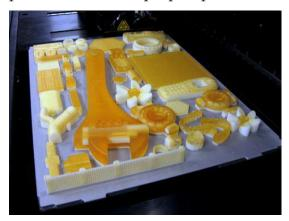
Exemplo de produtos fabricados em uma impressora 3D
