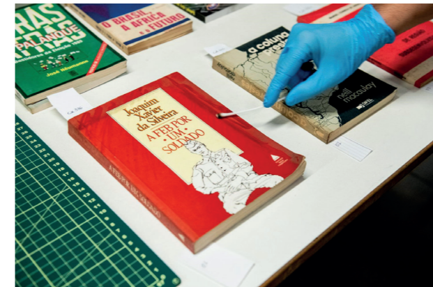
Coleta de amostra da superfície de livro com swab e transferência do material coletado para placa de Petri
