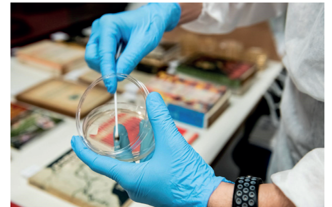
Coleta de amostra da superfície de livro com swab e transferência do material coletado para placa de Petri
