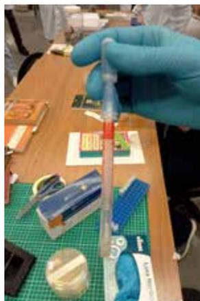
**Introdução do swab no frasco com reagente e do frasco no luminômetro**
