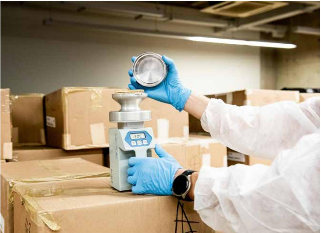
**Equipamento coletor de ar na quarentena.**
