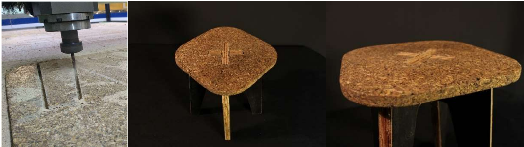
Figura 4a, 4b e 4c: a- Chapa de compósito sendo usinada em router CNC; b- Banqueta com assento em compósito; c- Detalhe do assento em compósito. Fonte: elaborado pelos autores.
