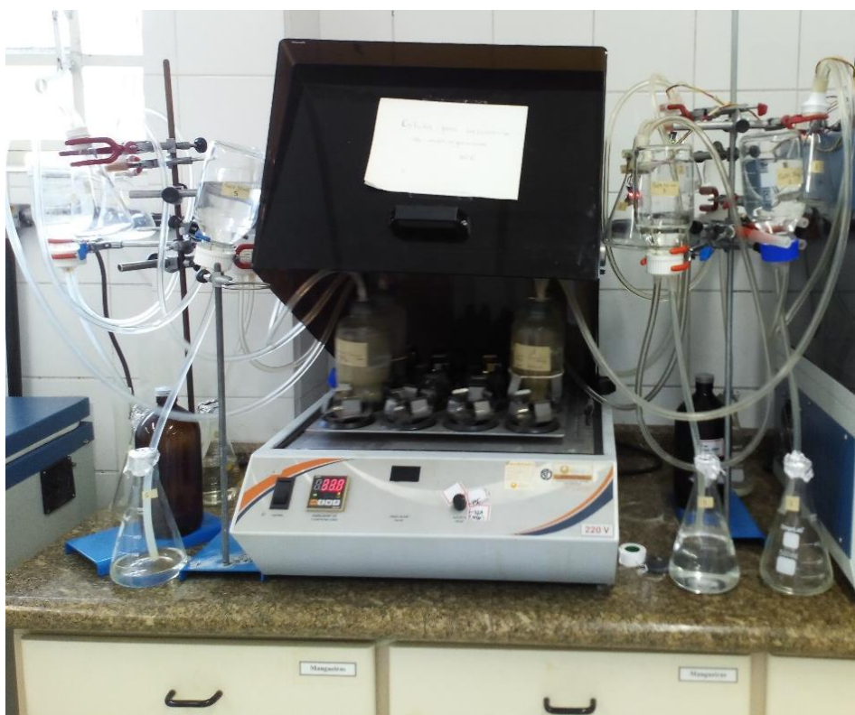
Figura 5.13 - Aparato experimental na análise da atividade metanogênica específica
