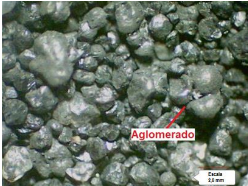
Figura 29 - Formação de aglomerado na amostra com 4% de resina do experimento 4, imagens obtidas pelo microscópio de bancada.
