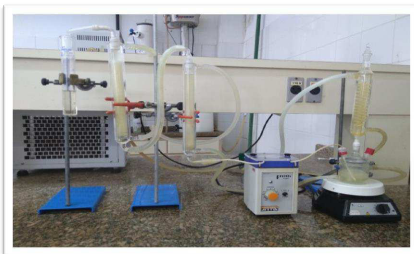
Figura 5.14 - Sistema reacional de duplo estágio utilizado nas reações de transesterificação do óleo de palmiste em regime contínuo
