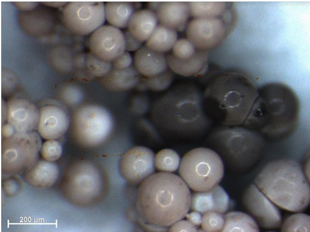
Figura 1 - Partículas de Poli (estireno-co-divinilbenzeno) produzidas no laboratório de biocatálise na EEL-USP.
