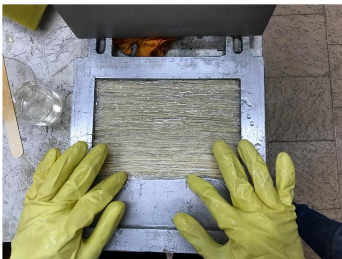
Figura 19 - Preparação do compósito de fibra natural contínua
