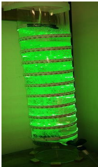
Figura 7 - Fotobiorreator do tipo coluna de bolhas, de formato cilíndrico com diâmetro de 15 cm, altura de 1 m e capacidade útil de 10 L.
