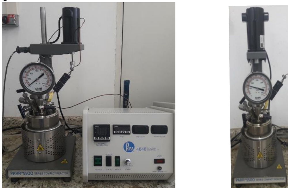
Figura 9 - Sistema utilizado nas reações de transesterificação direta da biomassa microalgal.
