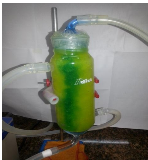
Figura 5.6. Análise visual da formação de caminhos preferenciais com a injeção de corante lipossolúvel no reator A.
