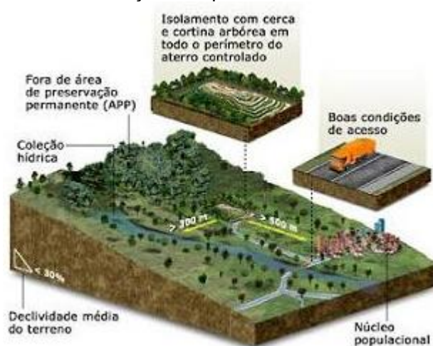
Figura 3 – Localização adequada de um aterro controlado.
