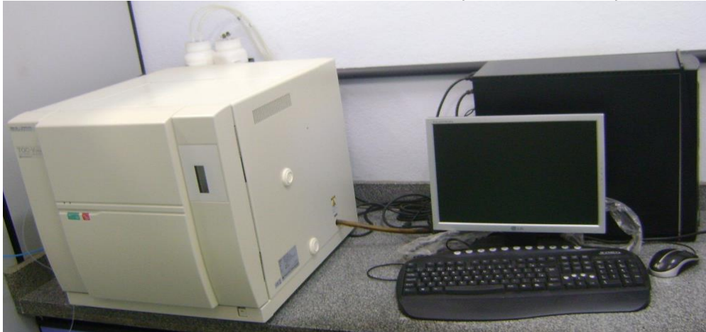
Figura 19 – Analisador de carbono total, para determinação da concentração de carbono.
