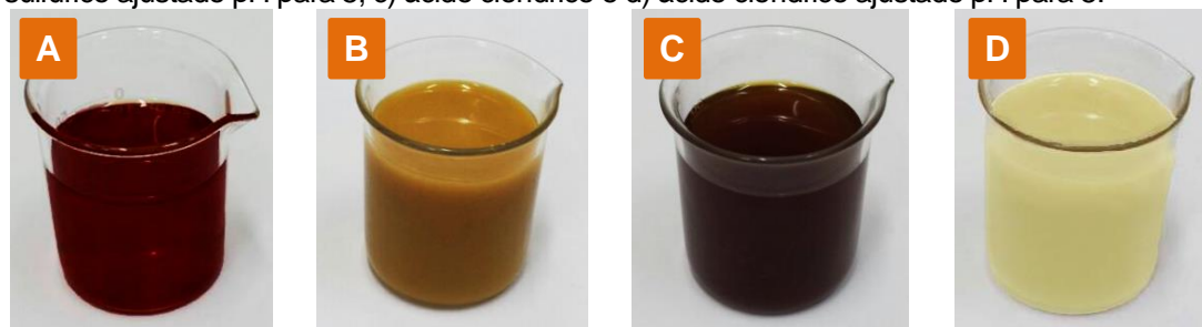
Figura 71 – Aspecto da solução alcalina de fosfato produzida com: a) ácido sulfúrico; b) ácido sulfúrico ajustado pH para 5; c) ácido clorídrico e d) ácido clorídrico ajustado pH para 5.
