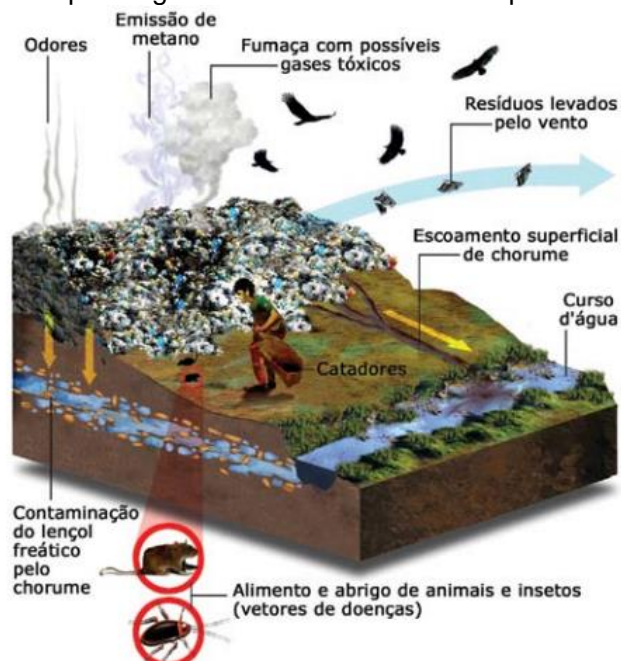
Figura 2 – Esquema genérico de um lixão e os impactos ambientais.
