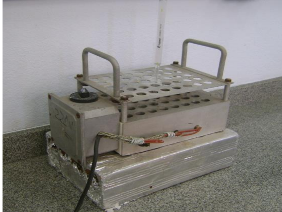
Figura 18 – Bloco digestor em alumínio com termômetro para análise de DQO, construído no LOM (departamento de Engenharia de Materiais).
