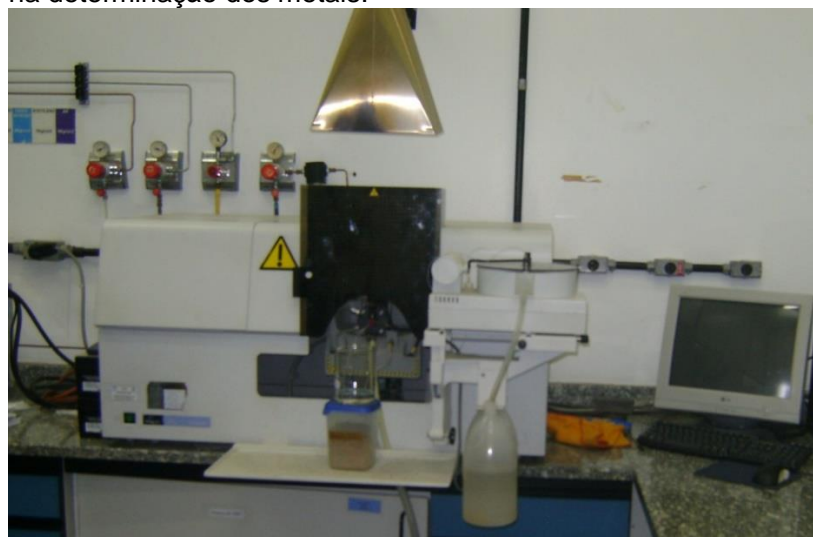
Figura 15 – Espectrômetro de absorção atômica (EAA), utilizado na determinação dos metais.
