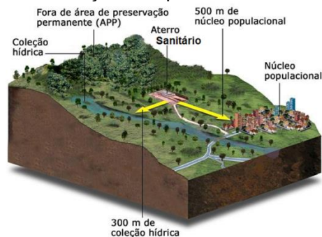
Figura 5 – Localização adequada de um aterro sanitário.
