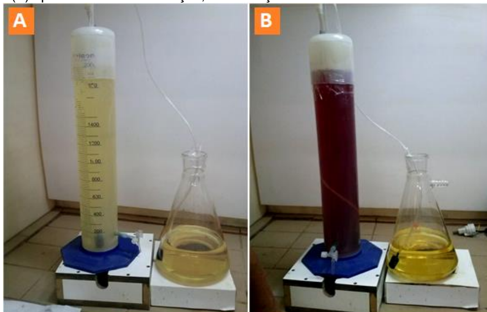
Figura 20 – Esquema para quantificação de ozônio em função da vazão de O 2 e potência do ozonizador: (A) antes da aferição, com solução levemente amarela e (B) após 15 minutos de reação, com solução amarela intensa ou castanha.
