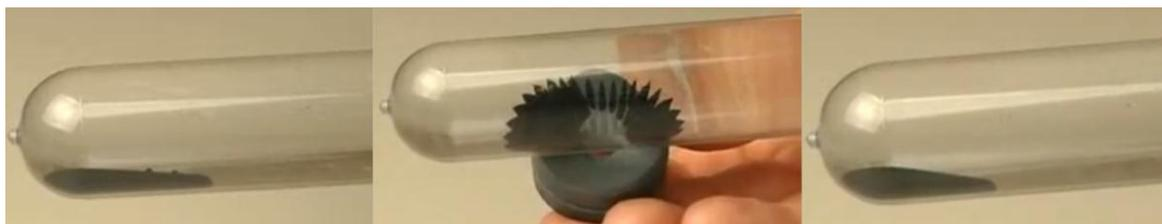
**Figura 3.4.** Aplicação de campo magnético em partículas superparamagnéticas.
