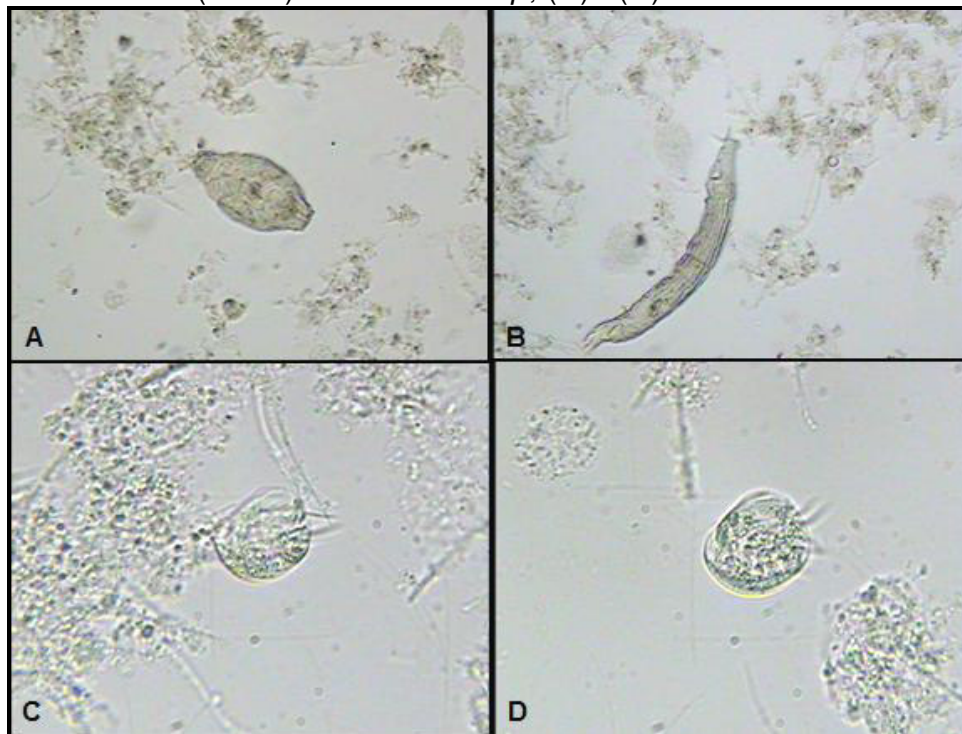
Figura 46 – Micrografia do lodo utilizado no tratamento biológico (ampliação de 400x para rotífero a 1000x para ciliados. Rotíferos semelhantes (A e B) Philodina sp, (C) e (D) Ciliado.
