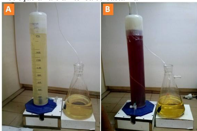
Figura 23 – Esquema para quantificação de ozônio em função da vazão de \text{O}_2 e potência do ozonizador: (A) antes da aferição, com solução levemente amarela e (B) após 15 minutos de reação, com solução amarela intensa ou castanha.
