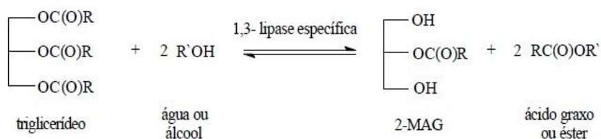
Figura 3.2 - Obtenção de monoglicerídeos por hidrólise ou alcoólise por via enzimática. Fonte: (BORNSCHEUER, 1995).
