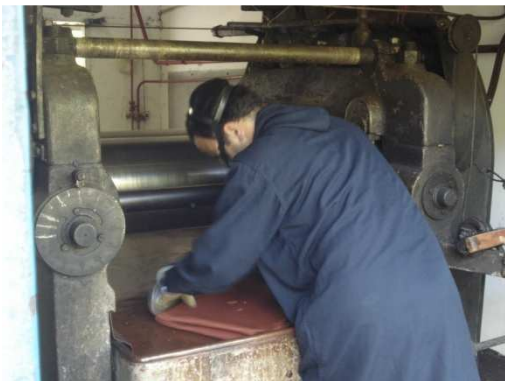
Figura 60 - Laminação Final – Fase 3
