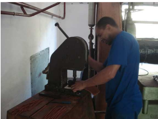
Figura 62 - Corte das tiras para teste químicos e balísticos
