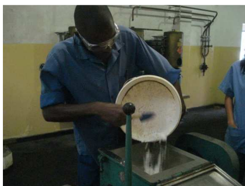
Figura 37 - Adição de Massa Primária
