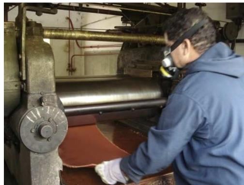
Figura 61 - Laminação Final – Fase 4
