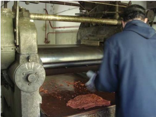
Figura 58 - Laminação Final – Fase 1
