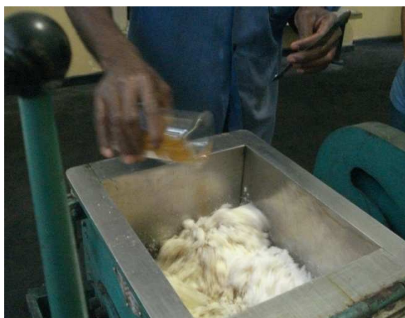
Figura 39 - Adição de Cromato de Cobre
