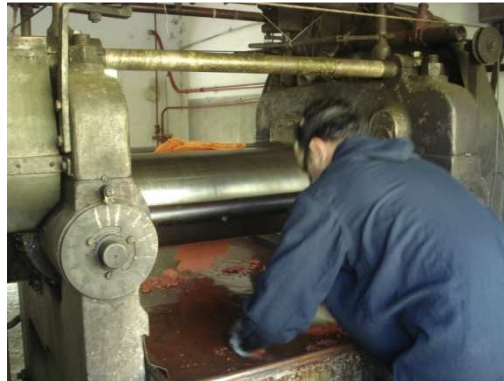
Figura 59 - Laminação Final – Fase 2
