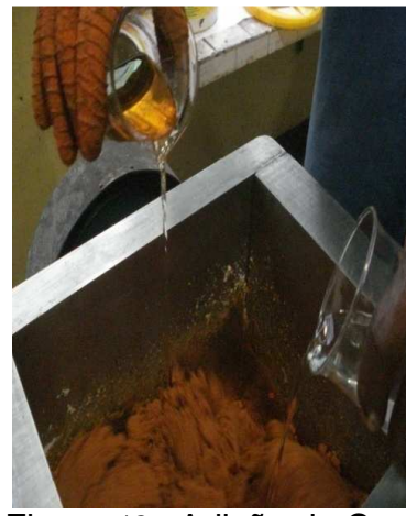
Figura 48 - Adição da Cera de Abelha e do Dibutilftalato
