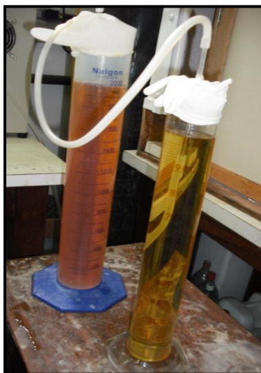
Figura 9 — Esquema para quantificação de ozônio em função da vazão de oxigênio de entrada e da potência do ozonizador
