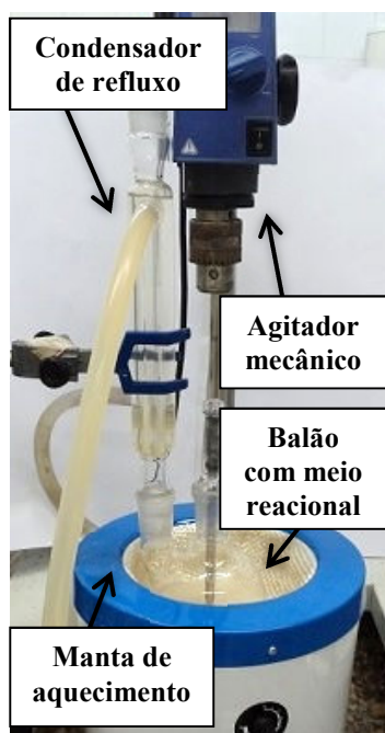
Figura 4.4 – Montagem experimental para as reações de síntese de biodiesel.
