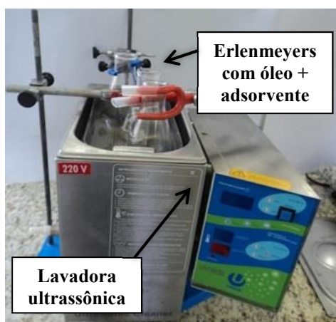
Figura 4.1 – Montagem experimental para os ensaios de desacidificação por adsorção.
