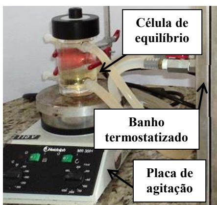
Figura 4.3 – Montagem experimental dos experimentos de extração líquido-líquido.
